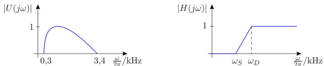
Abbildung 2: Spektrum des Eingangssignals und Frequenzgang des Hochpassfilters zu Aufgabe 1.
