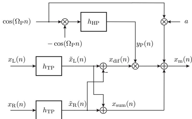
wobei es sich bei  $h_{TP}$  um ein ideales Tiefpass- und bei  $h_{HP}$  um ein ideales Hochpassfilter handelt. Die Grenzfrequenzen der Filter liegen identisch bei  $\Omega_C$  und es gilt:  $\Omega_C < \Omega_P$ .
